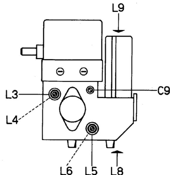
Veduta laterale dello chassis, con indicazione dei punti di accesso per effettuare l'allineamento di alcuni circuiti accordati.
