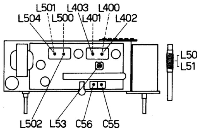
Disegno in pianta del telaio: sono indicati i nuclei per la regolazione dell'induttanza, durante l'allineamento, delle bobine dei circuiti accordati. Inoltre, è messa in evidenza la posizione di alcuni compensatori, e delle induttanze dell'antenna interna.
