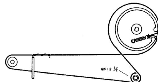
Disegno schematico del percorso della funicella per il comando dell'indice della scala parlante: la funicella compie due giri e mezzo intorno al perno di comando azionato dalla manopola.
